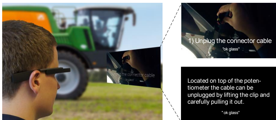
Abb. 9. Prototyp des Smart Glasses-basierten Informationssystems (aus B5; Metzger et al. 2016b)
