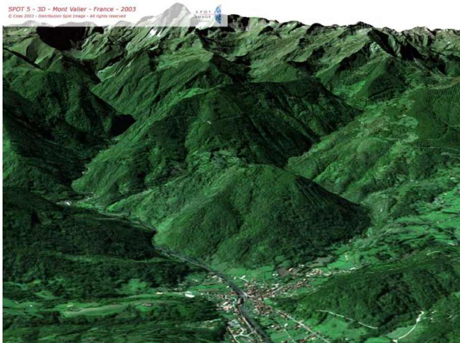
Abbildung 3.43: Die Stereo-Aufnahmen von SPOT 5 erlauben auch die 3D Rekonstruktion eines Gebiets, hier des Mont Valier [680]
