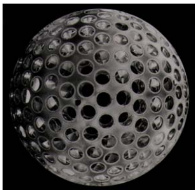
Abbildung 2.6: LAGEOS 1 als kompakter Laserreflektor [436]
