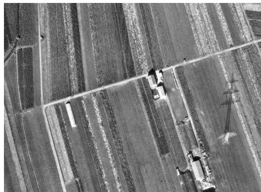
Abbildung 2.12: Ein Gegenstand kann manchmal über seinen Schatten wesentlich einfacher zu identifizieren sein als direkt, wie in dieser Luftaufnahme am Mast der Hochspannungsleitung deutlich wird [71]
