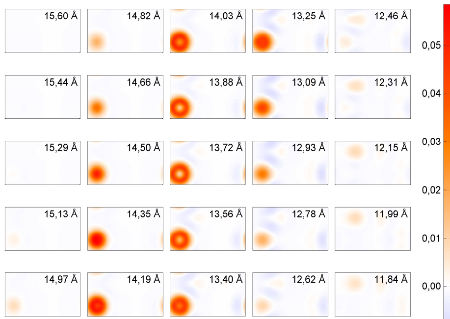
Abbildung 5.8: Darstellung der Ladungsverteilung des zusätzlichen Elektrons der Phosphorfehlstelle. Die Verteilung ergibt sich als Differenz der Ladungsverteilung der Systeme P1 zu SiP1. Abgebildet sind 25 Querschnitte entlang der (111)-Richtung. Der mittlere Querschnitt befindet sich auf Höhe der Fehlstelle 1.
