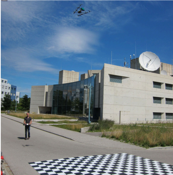
Abb. 5.9: Geometrische Kalibrierung der Thermalkamera mit einem 5 x 5 m großen Testfeld.
