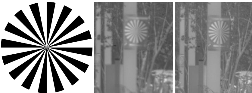
Abb. 4.14: Siemensstern zur Fokuseinstellung. Je besser der Fokus der Kamera eingestellt ist umso kleiner ist der unscharfe Bereich in der Mitte des Siemenssterns. Auf dem Bild in der Mitte ist der Fokus nicht so gut eingestellt wie auf dem Bild rechts.
