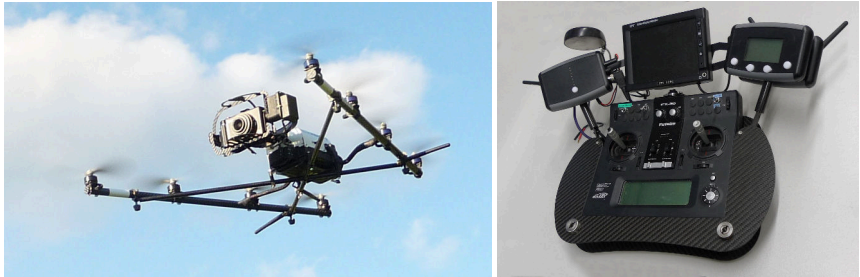
Abb. 3.4: Links: Der FALCON 8 von Ascending Technologies mit einer Lumix LX-3 Kamera aus dem Jahr 2011. Rechts: Die zugehörige mobile Bodenstation.
