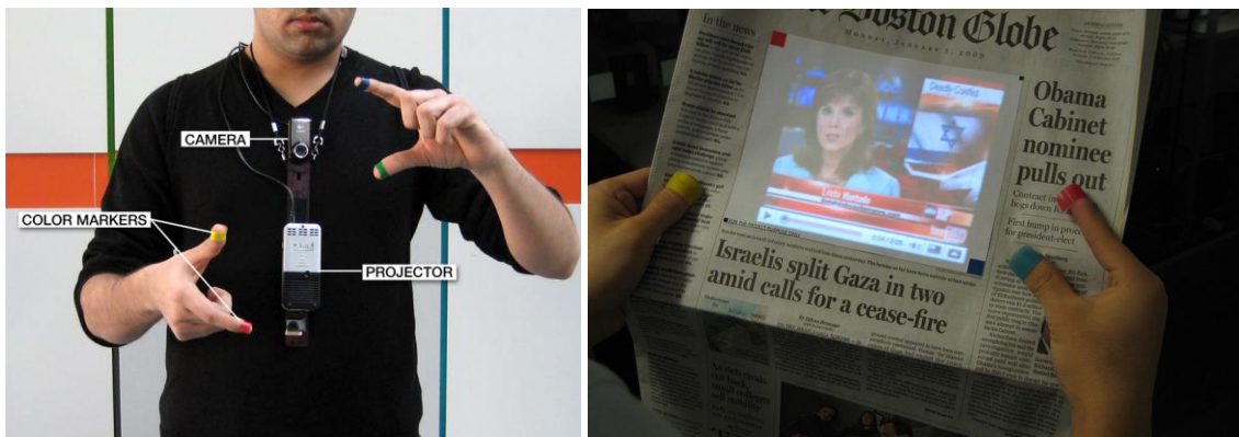
Abb. 2. Darstellung der SixthSense-Technologie am Körper getragen (links) und Anwendung der Projektion an einer Tageszeitung (rechts) (Quelle: Mistry 2015)
