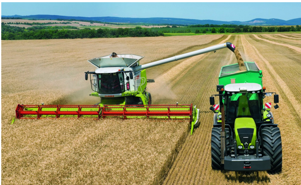
Abbildung 2.4: Fahrzeuge in dem Anwendungsfall Infield-Transportlogistik [25]. Es wurde ein Mähdrescher des Typs CLAAS LEXION 760 als Erntefahrzeug (links) und ein Schlepper des Typs CLAAS XERION mit einem Überladewagen von HAWE als Überladefahrzeug (rechts) eingesetzt. Das Bild zeigt einen Überladevorgang in Parallelfahrt.
