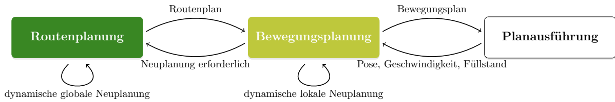
Abbildung 5.4: Dynamische Neuplanung bei Abweichungen in der Planausführung. Bei Abweichungen wird die Bewegungsplanung lokal neu ausgeführt. Wenn dabei der Routenplan nicht eingehalten werden kann, wird eine dynamische globale Neuplanung durch die Routenplanung durchgeführt. In diesem Fall wird der neue Routenplan auf jeder Maschine durch die Bewegungsplanung verfeinert, bevor er ausgeführt wird.
