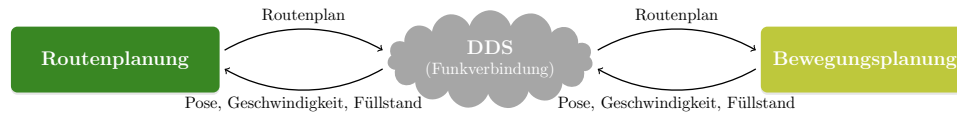
Abbildung 5.1: Anbindung der Routen- und Bewegungsplanung. Die zentrale Routenplanung stellt jedem Fahrzeug über Funk per DDS einen Routenplan bereit, der auf jeder Maschine lokal durch eine fahrzeugtypspezifische Bewegungsplanung verfeinert wird. Ergebnis der Bewegungsplanung ist ein durch die Maschine abfahrbarer Pfad, der den Routenplan erfüllt.
