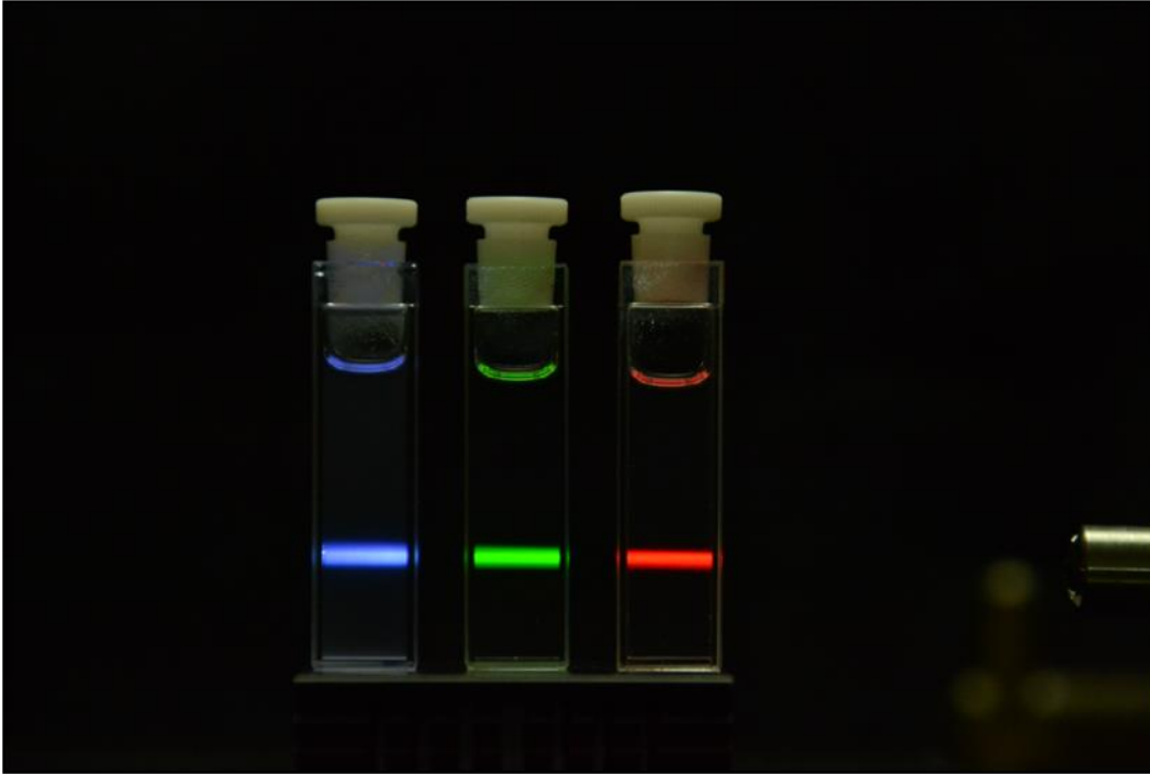
Abbildung 4.5: Fotos von Lösungen mit links: 14 nm \beta -NaY 79,8% F 4% :Tm 0,2% -NP mit einer NaYF 4 -Schale, mitte: 14 nm \beta -NaYF 4 :Yb 20% ,Er 2% -NP mit einer NaYF 4 -Schale und rechts: 6 nm kubische NaMnF 3 :Yb 20% ,Er 2% -NP gelöst in Hexan. \lambda_{\text{Anr.}} : 978 nm, Dauerstrich, 1 W
