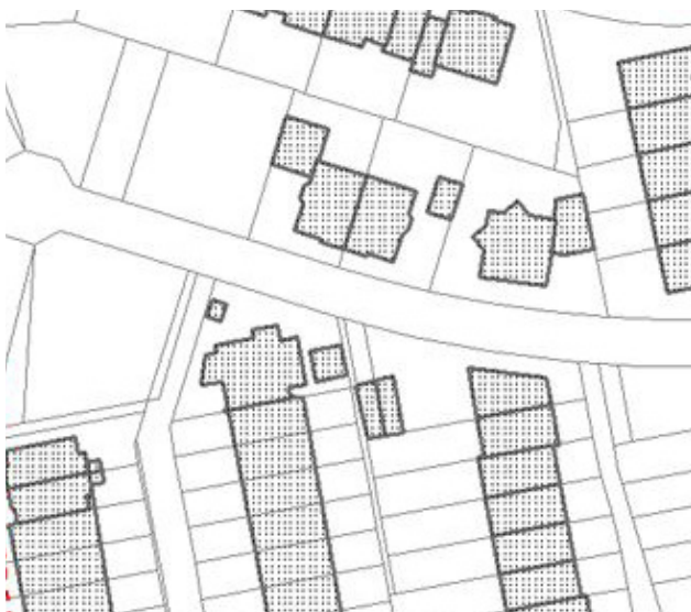
Abbildung 2 DOM-Laserscandaten innerhalb der Gebäudegrundrisse
