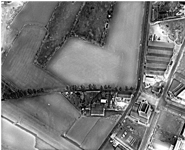
Abb. 9: Neue Intensitätskomponente nach Addition des gefilterten panchromatischen Bildes und der gefilterten Intensitätskomponente des multispektralen Bildes.
