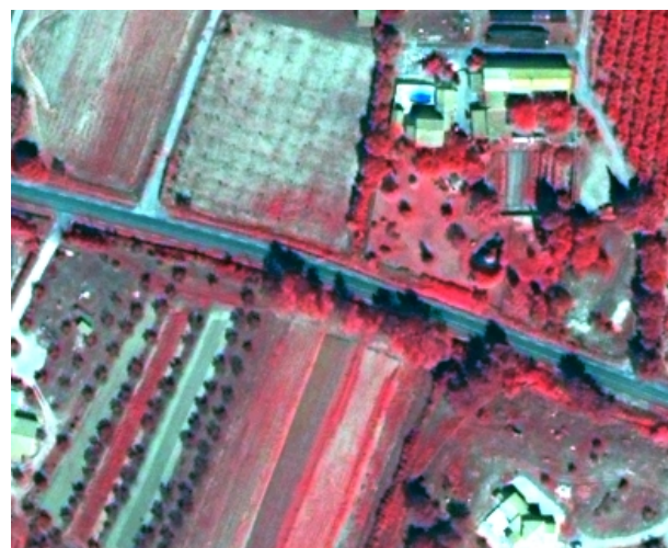
Abb. 12b: Singlesensor, unitemporale Ehlers Fusion: Quickbird multispektral und panchromatisches Bild mit der Bandkombination NIR, rot, grün
