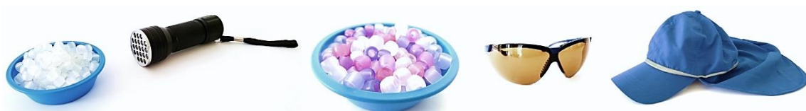
Abbildung 9: Edukatives Element: Experiment mit sog. „UV-Perlen“ zur Sichtbarmachung von UV-Strahlung durch eine UV-Taschenlampe sowie Schutzwirkungen von PSA (Eigene Darstellung)
