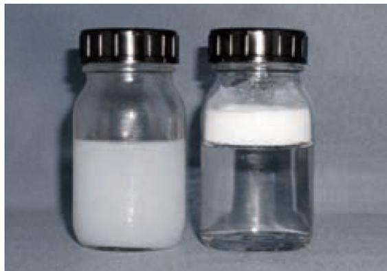
**Abbildung 2.47:** Wasser mit hydrophilem Aerosil<sup>®</sup> (links) und hydrophoben Aerosil<sup>®</sup> nach einer Oberflächenmodifizierung (rechts).<sup>[188]</sup>
