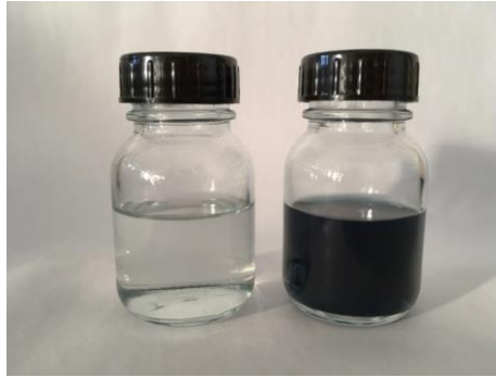
Abbildung 4-41 Kolloidale Lösungen von \text{SnO}_2\text{:Sb} -Nanopartikeln. Links: Eine klare, farblose Lösung direkt nach der Synthese. Rechts: Eine klare, blaue Lösung nach der Behandlung im Autoklaven. Die Plasmonen-Absorption im IR-Bereich führt zu der Blaufärbung des Kolloids. [141, 142]
