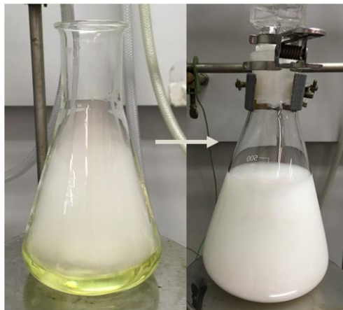
Abbildung 4-37 Reaktionslösungen während der Chlorid-Syntheseroute. Links: Die Zugabe der Ausgangsverbindungen \text{SnCl}_4 und \text{SbCl}_5 in \text{HCl} führen zu einer klaren, gelblichen (und rauchenden) Lösung. Rechts: Durch die Zugabe von Ammoniakwasser (bzw. Säuren bei der Hydroxo-Syntheseroute) werden das Zinn und das Antimon als \text{SnO}_2 - bzw. \text{Sb}_2\text{O}_5 -Hydrate ausgefällt.
