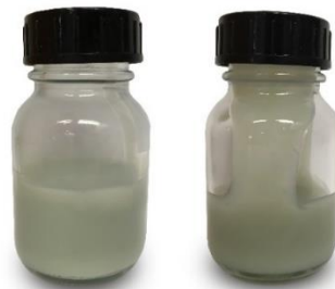
Abbildung 4-44 Verschiedene Pasten mit unterschiedlichen Viskositäten, die für den jeweiligen Gebrauch als Rakel- oder Druckpaste eingestellt wurden. Links eine Paste mit geringerer Viskosität für den Druckprozess. Die Paste hat sich nach dem Schütteln des Gefäßes schnell wieder am Boden abgesetzt. Rechts eine Paste mit höherer Viskosität für den Rakelprozess, was anhand der noch am Glasgefäß haftenden Pasten-Rückstände nach vorherigem Schütteln zu erkennen ist.
