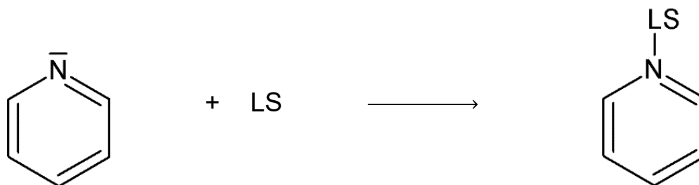
Abb. 3.3: Lewis-Base-Funktion des Stickstoffatoms im Pyridinmolekül
