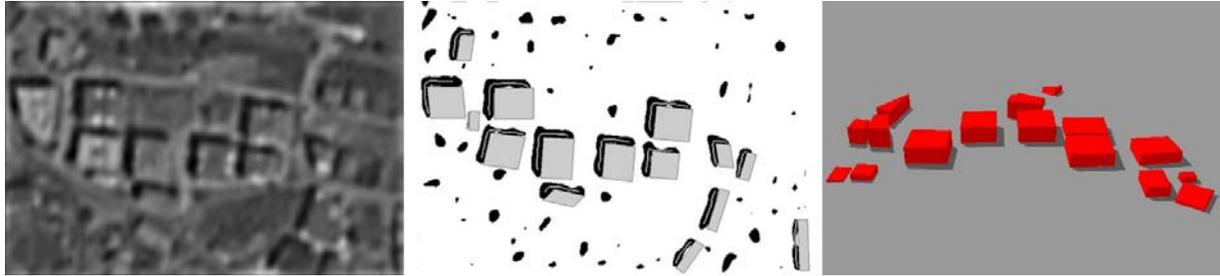
Auf Basis von Cartosat-Satellitenbildern (links) werden durch Schattenanalyse approximativ 2D-Grundrisse (Mitte) und 3D-Gebüdemodelle (rechts) vom Testgebiet Istanbul zum Zweck der Veränderungsanalyse erzeugt.
