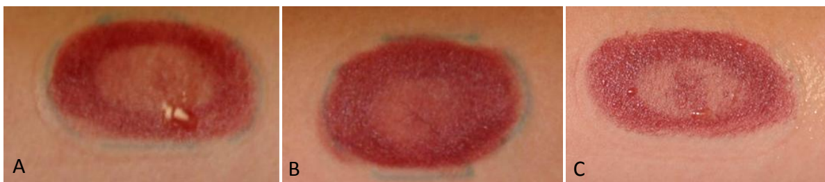
Abbildung 30: Reinigungsergebnisse mit Nitrilüberzug und Teppichgleitern
