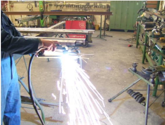
Abbildung 9: Berufsbild Metallkonstruktion: Schneiden von Edelstahl
