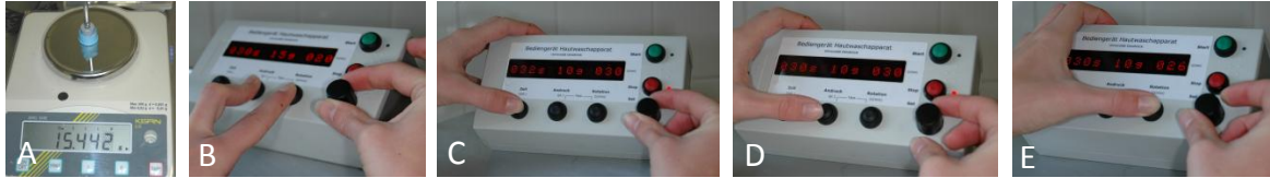
Abbildung 39: Einstellen der Parameter am OHWA
