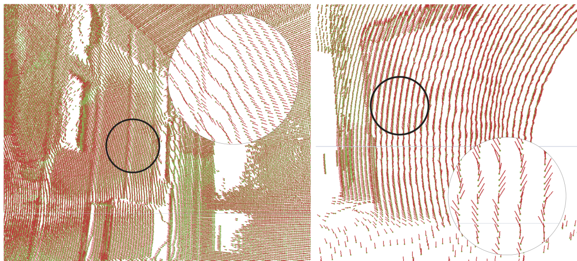
Abbildung 3.8: Beispiel für die Fluktuation von Normalen aufgrund zu kleiner k -Nachbarschaft mit k_n = 5 . Man kann deutlich erkennen, dass mit abnehmender Punktdichte die Normalen um die einzelnen Scanlinien schwanken und teilweise ihre Richtung stark ändern (vor allem im rechten Ausschnitt).
