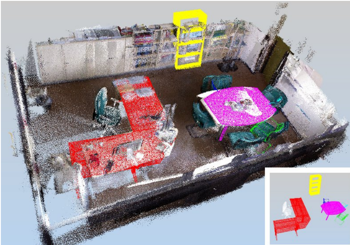
Abbildung 5.17: Registrierte Punktwolke der Büroumgebung mit erkannten Möbeln. Der Bildausschnitt unten rechts zeigt die Positionen der erkannten Modelle ohne Punktdaten.
