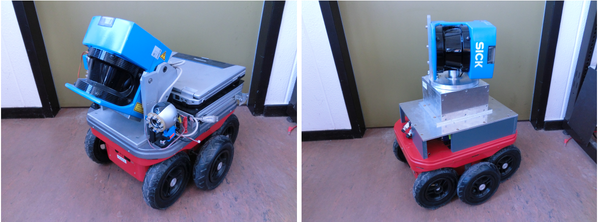
Abbildung 2.2: Die Roboter Kurt3D mit nickendem SICK LMS 200 Laserscanner (links) und Kurt360 mit Rotationseinheit (rechts), die als Testplattform für das Rekonstruktionsverfahren dienen sollen. Die maximale Auflösung des verwendeten 2D-Laserscanners beträgt 721 Punkte pro Scan bei einem Öffnungswinkel von 180^\circ . Der Winkelbereich des nickenden Scanners beträgt maximal 120^\circ mit einer Winkelauflösung von bis zu 0.5^\circ . Die Rotationseinheit kann kontinuierlich Daten aufnehmen, der minimale Drehwinkel zwischen zwei 2D-Scans beträgt 0.035^\circ .
