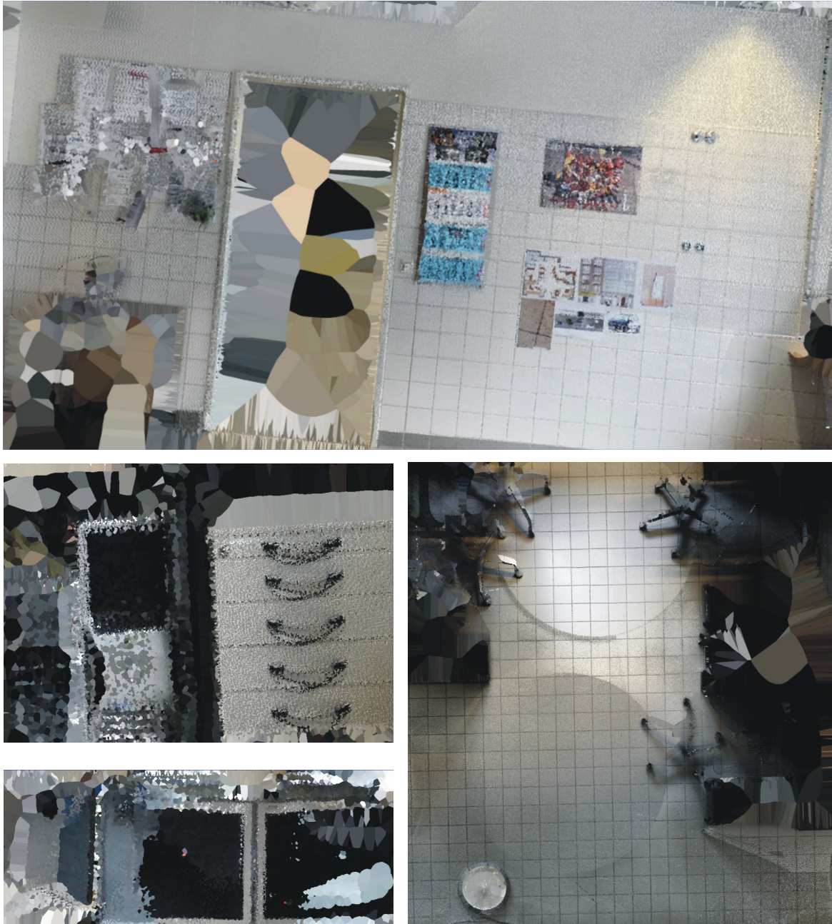
Abbildung 4.8: Beispiele für berechnete Texturen im Büroscan für die hintere Wand (oben, Originalgröße 16384 \times 8192 Pixel), Rollkästen und Monitore (linke Spalte, 2048 \times 2048 bzw. 2048 \times 512 Pixel im Original) und Fußboden (rechte Spalte, 4096 \times 4096 ).
