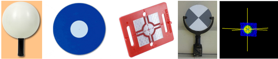
Abbildung 2.6: Verschiedene Marker zur Registrierung von 3D-Laserscans. Das linke Bild zeigt eine Kugel als Referenzgeometrie. Die mittleren Bilder zeigen verschiedene Klebmarker mit Referenzmustern [20, 105]. Das rechte Bild zeigt die gemessene Reflektivität der Markeroberfläche. Man kann gut erkennen, dass sich das Zentrum der Markierung deutlich vom Hintergrund absetzt [105].
