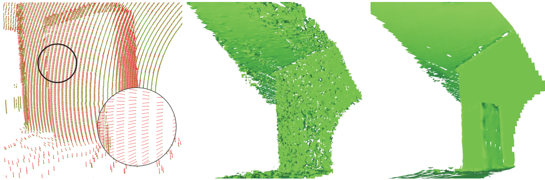
Abbildung 3.10: Einfluss der adaptiven Normalenschätzung auf die der Qualität der Normalen und die Rekonstruktion. Das linke Bild zeigt das Ergebnis der Normalenschätzung mit Anpassung der k_n -Nachbarschaft. Das mittlere Bild zeigt eine Rekonstruktion basierend auf Normalen ohne Adaption, das rechte Bild zeigt die Rekonstruktion mit optimierten Normalen.
