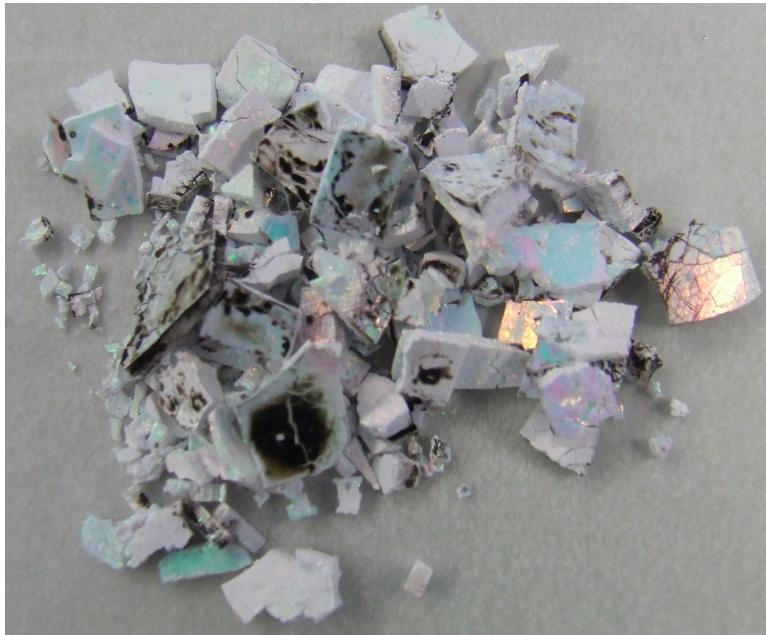
Abb. 5.13: Foto eines inversen Opals mit Kohlenstoffrückständen
