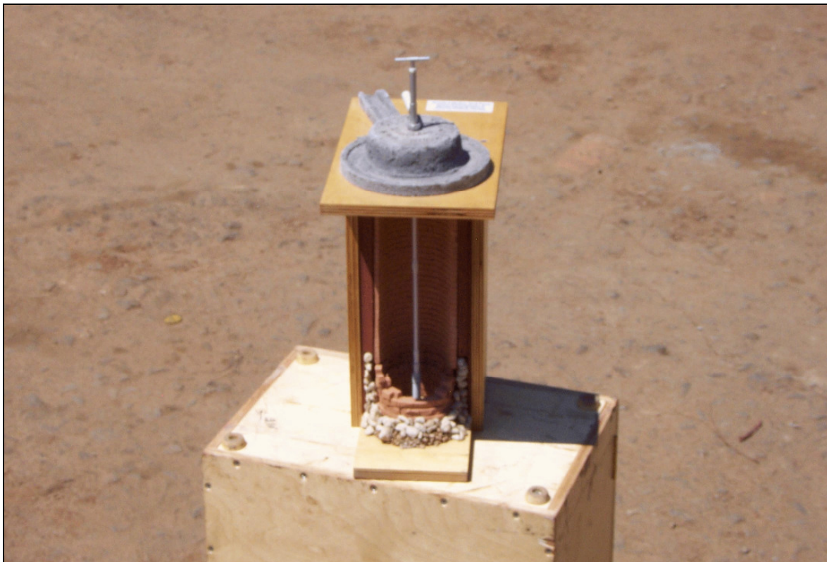
Abb. 24: Modell eines Schachtbrunnens (Shallow Well) mit MARK V Pumpe (eigenes Foto)
