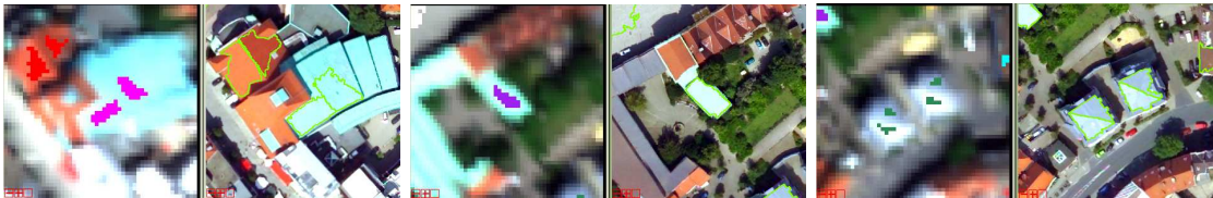
Abbildung 7.10: Nicht zusammengefasste Cluster der Kupfermaterialien (links und Mitte). Zinkmaterialien werden trotz unterschiedlicher Dachneigungen korrekt geclustert (rechts)
