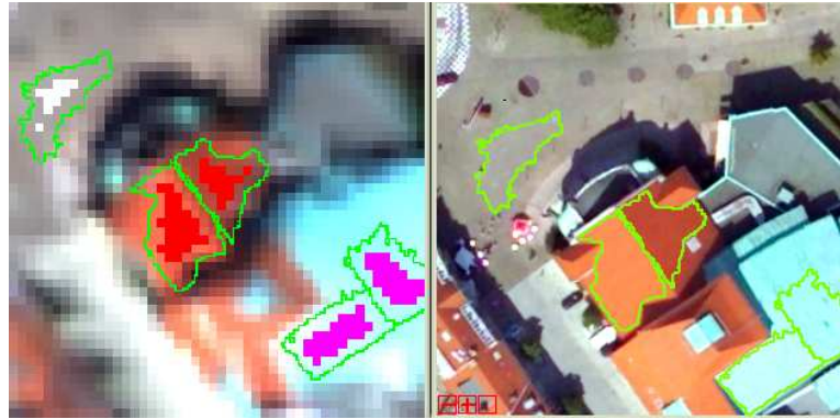
Abbildung 4.20: Geclusterte Referenzkandidaten (links) in den Segmenten des Orthophotos (zum Vergleich rechts). Die Referenzkandidaten sind je nach Cluster eingefärbt (weiß = Betonpflasterung, rot = Tondachpfanne und violett = Kupferdach).
