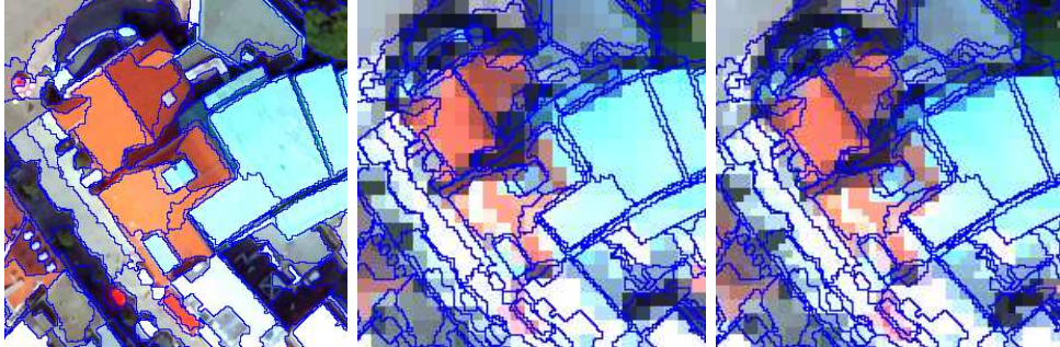
Abbildung 6.24: Bilddaten nach einem Nearest Neighbor Resampling (Mitte). Auch bei einem undersampling (Faktor 2) bleiben Treppeneffekte sichtbar (rechts). Links der entsprechende Ausschnitt eines Orthophotos.
