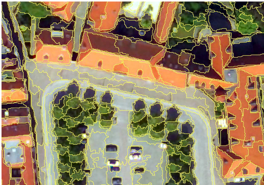
Abbildung 1.1: Ausschnitt eines Luftbildes der Osnabrücker Innenstadt. Sichtbar sind neben einem Parkplatz die eingrenzenden Bäume und die Dächer der umliegenden Gebäude. Die geometrische Abtastung von 25 cm ermöglicht die automatisierte Ableitung von Objektteilgeometrien durch eine Bildsegmentierung (Grenzen der Segmente sind gelb dargestellt). Einzelne Objektteile wie Dach-, Straßen- und Schattenflächen werden klar voneinander getrennt.
