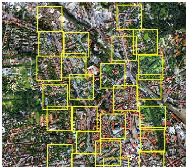
Abbildung 6.13: Orthophoto Mosaik bestehend aus dem Mosaik der Aufnahmen aus der Leo2004-25 Kampagne (Hintergrund) und Bildausschnitten nahe der Projektionszentren aus der Leo2004-15 Kampagne (gelb).
