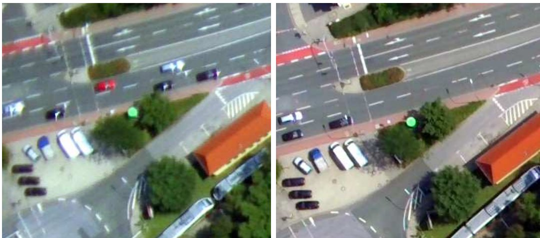
Abbildung 6.9: Bildqualität der Kodak DC14n. In Randbereichen der Aufnahmen treten Unschärfen auf (links). Zum Vergleich rechts: Ein Folgebild aus dem Flugstreifen, in dem der Ausschnitt in der Bildmitte liegt.
