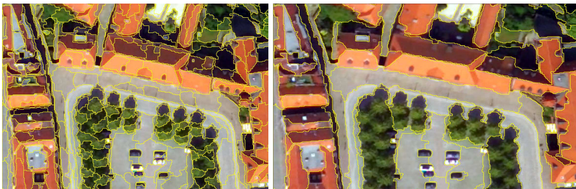
Abbildung 3.6: Einfluss des Skalenparameters auf das Ergebnis der Bildsegmentierung. Dieser ist im linken Bild mit 30, in rechten Bild mit 100 gewählt.
