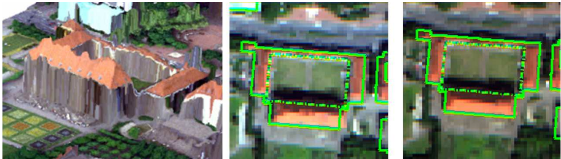
Abbildung 6.21: Einfluss des Höhenmodells auf die parametrische Geokodierung. Wird die Objekthöhe (links) nicht berücksichtigt erfolgt keine korrekte Geokodierung (Mitte), das korrekte Ergebnis ist rechts dargestellt.
