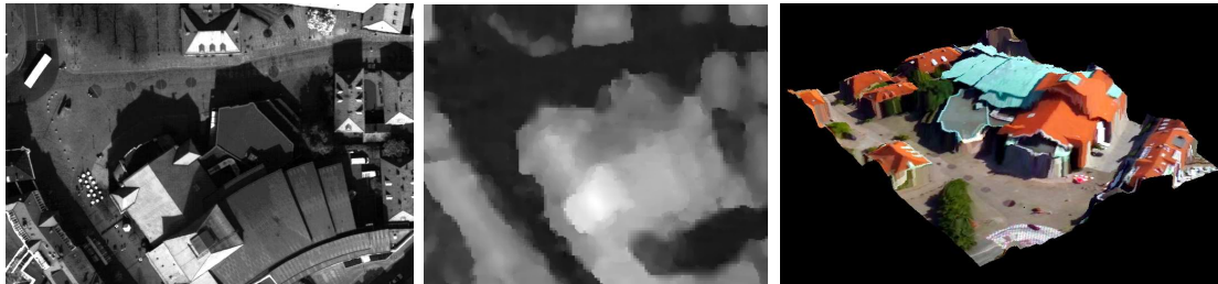
Abbildung 6.4: Digitales Oberflächenmodell der HRSC-A. Links: panchromatischer Nadirkanal, Mitte: HRSC-A DOM, rechts: Digitales Orthophoto (LEO) projiziert auf das DOM der HRSC-A
