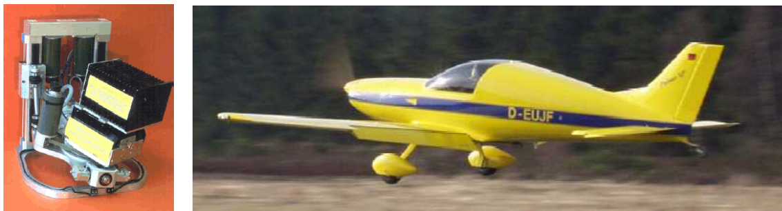
Abbildung 6.6: Das LEO System. Links: Plattform mit Kamera und INS, rechts das Pulsar XP Leichtflugzeug
