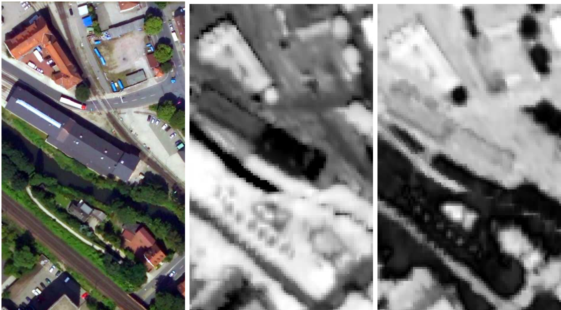
Abbildung 3.8: Winkelwerte des SAM als Bild (sog. rule image ). Links ein Ausschnitt aus dem Luftbild, in der Mitte das rule image für das Material „Wasser“ und rechts das Material „Vegetation“. Dunkle Flächen stellen einen kleinen Winkel dar, der aus einer hohen Übereinstimmung zwischen Bildpixel und Referenzspektrum resultiert.
