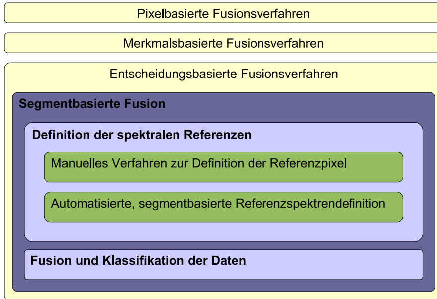
Abbildung 1.4: Kontext und Schwerpunkt der Arbeit. Die automatisierte segmentbasierte Referenzspektrendefinition ist eingebettet in die segmentbasierte Fusion, einem entscheidungsbasierten Fusionsverfahren.
