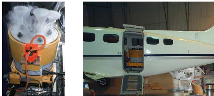
Abbildung 6.14: HyMap Sensor: Kühlung der Spektrometer (links) und eingebaut in Flugzeug (rechts) ( www.caf.dlr.de , www.hyvista.com , zuletzt besucht im Januar 2006).
