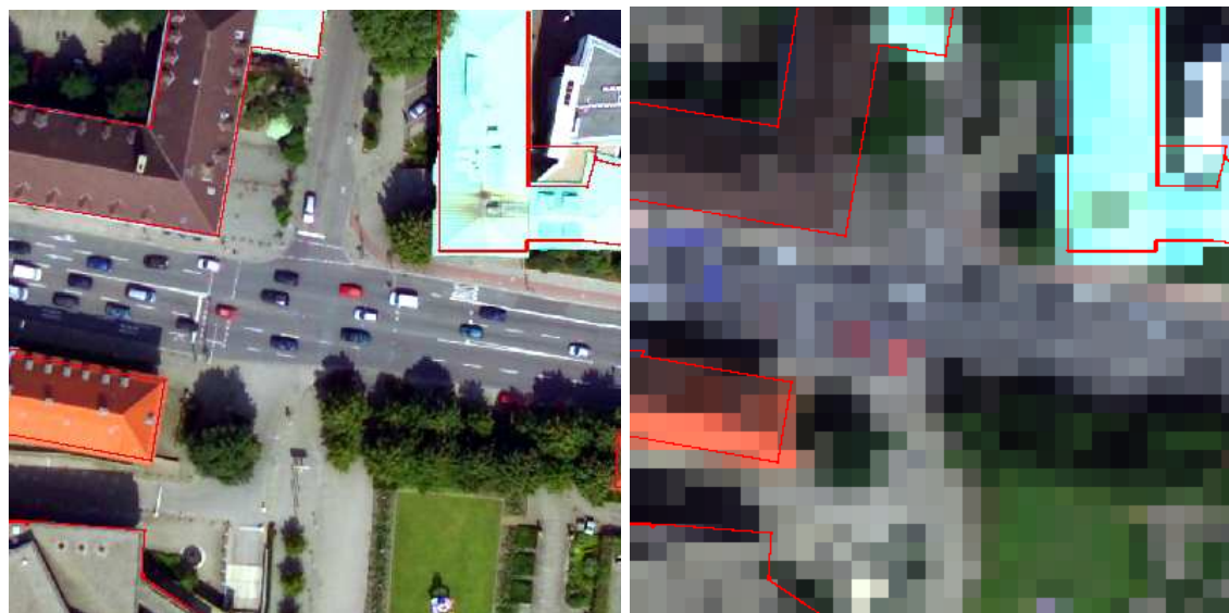
Abbildung 2.12: Vergleich der geometrischen Abtastrate zwischen einem geometrisch hochauflösenden (0.25 m GSD) und einem hyperspektralen Sensor (3 m GSD)
