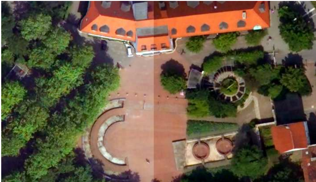
Abbildung 6.10: Der individuelle Weißabgleich führt zu unterschiedlicher Radiometrie der Einzelaufnahmen. Besonders stark wirkt sich der AWB-Modus in benachbarten Flugstreifen aus.
