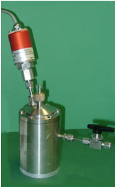
Abbildung 17: Pufferkammer zur Vorinkubation des Meßpuffers DB1. Nach rechts ragt das Kugelhahnventil zur Begasung der Kammer heraus. In rot ist der Drucksensor zu erkennen.
