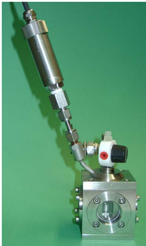
Abbildung 16: Druckzelle für spektroskopische Messungen unter erhöhtem Druck. Ansicht auf das Saphirglasfenster für den anregenden Laserblitz. Der nach links oben herausragende Aufsatz trägt den Drucksensor.
