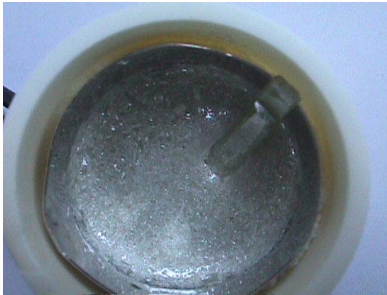
Abbildung 3-3: Tiegel mit festgewachsenem Kristall. Da der Kristall nicht in der Mitte aus der Schmelze ragt, ist zu vermuten, dass das Ende des Kristalls zum Zeitpunkt der Kristallisation der Schmelze nicht an der Schmelzoberfläche, sondern auf dem Boden stand.
