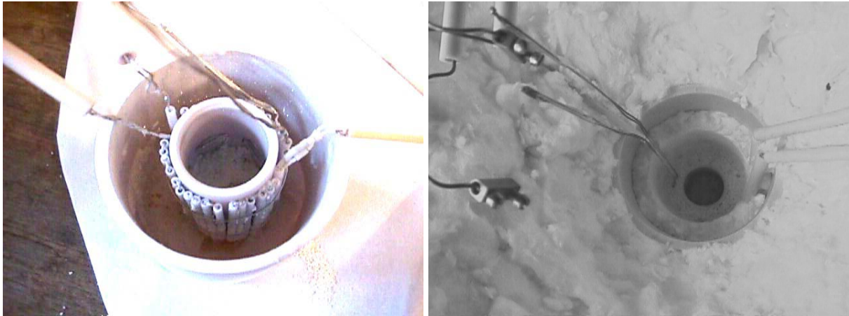
Abbildung 4-2: Auf dem linken Bild führt der Blick auf die beiden unteren, inneren Heizelemente. Um den inneren Keramikzylinder herum sieht man die zur elektrischen Isolierung in Keramikröhrchen gefassten Platinheizdrähte. In dem inneren Zylinder ist der horizontal spiralförmig gewickelte Platindrabt des innersten Heizelements zu sehen – wiederum in Keramikröhrchen gelegt. Rechts ist die Zuführung für das Thermolement zur Regelung des inneren Ofens angebracht. Der Tiegel steht auf Korundkügeln. Auf dem rechten Bild ist der eingebaute innere Heizer zu sehen. In der Mitte ist der im linken Bild gezeigte innere Keramikzylinder abgebildet.
