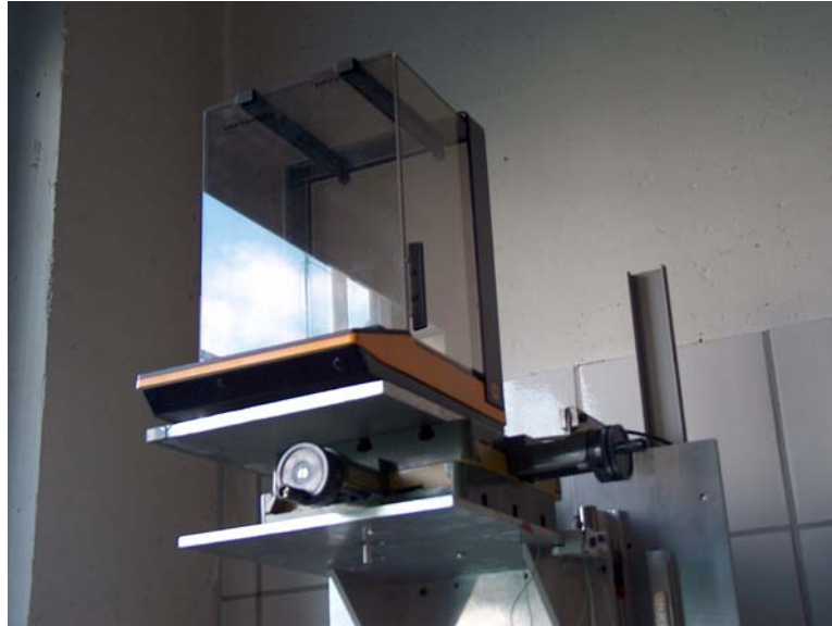
Abbildung 4-3: Der über dem Ofen angebrachte Waagentisch mit Waage. Unter dem Waagentisch ist der Halter für das Thermoelement zu sehen.
