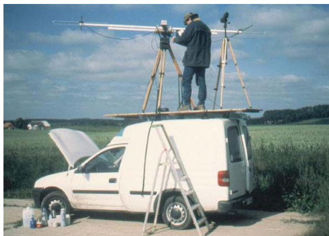
Abb. 2: Antennenstation auf dem Dach des Beobachtungsfahrzeuges.
