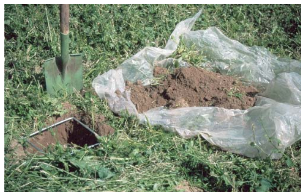
Abb. 4: Erfassen der Regenwurmdichte (Lumbricidae) innerhalb eines Erdblockes von 0,25 x 0,25 x 0,20 m 3 durch Handauslese.
