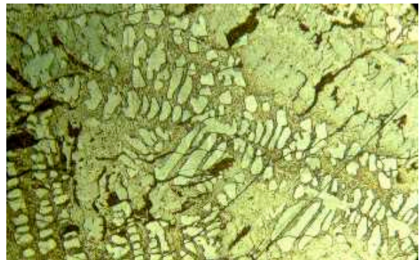
Abb. 4-12: x_{\text{Ga}} = 0,1000 , Tempern bei 700 °C.
