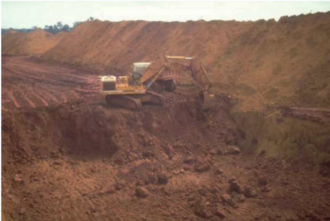
Abbildung 5.5: Mit schweren Maschinen wird das Bauxit entnommen und auf LKWs verladen, die es zu Förderbändern bringen.
