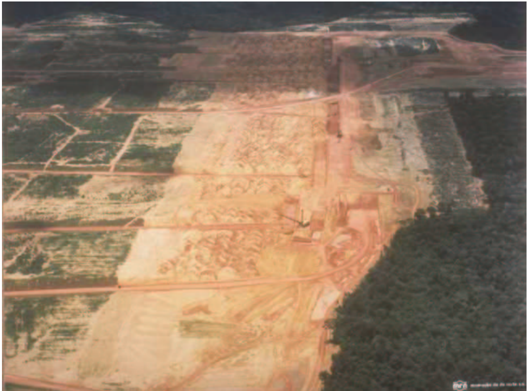
Abbildung 5.1: Bei dem Abbau von Bauxit und der anschließenden Aufforstung wird streifenförmig vorgegangen. Zuerst werden die Bäume aus dem Primärwald umgebrochen und die Biomasse von der Oberfläche entfernt. Der Oberboden mit seinem organischen Material, Samen und auskeimungsfähigen Pflanzenteilen wird abgetragen und auf die aufzuforstenden Flächen aufgebracht. Rechts auf dem Photo ist der Primärwald zu sehen, davor die umgebrochenen Bäume und die schon von der Biomasse befreiten Flächen. Vor der Entnahmestelle des Bauxits und den davor aufgeschütteten Lehmbergen, die im Anschluß an die Entnahme in die Gruben zurückgefüllt werden, sind links auf dem Photo die schon aufgeforsteten Flächen an ihrer Vegetationsdecke deutlich zu erkennen. Photo: MRN
