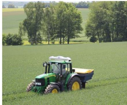
Abbildung 26: Traktor mit Stickstoff-Sensor auf dem Dach für eine teilflächenspezifische Düngung (Agricon GmbH)
