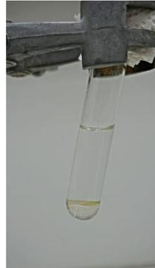
Abbildung 6: Positive Ringprobe bei der Düngerprobenlösung
